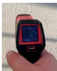
9) Kontrola připravenosti podkladu – kontrola povrchové teploty.
